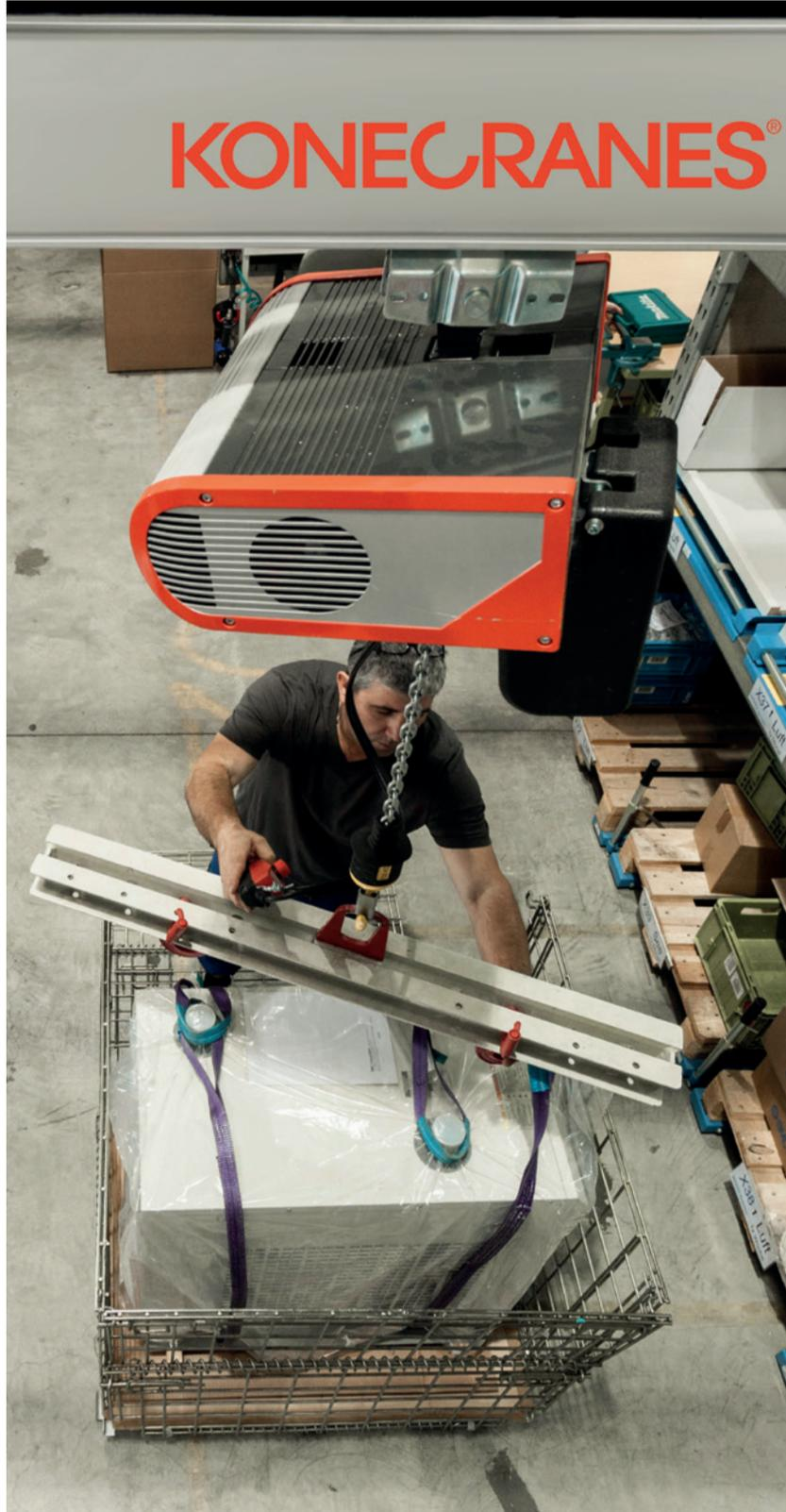
Konecranes hat für die SMC Pneumatik GmbH zwei Aluminium-Einträgerleichtkrane konzipiert und installiert.
